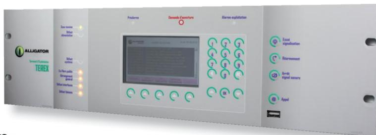
Le **TEREX** est un terminal d'exploitation qui contrôle plusieurs UGCIS Alligator 64. Il permet de gérer un ensemble de portes d'issues de secours maintenues verrouillées par des Dispositifs Actionnés de Sécurité (DAS) reliés aux centrales UGCIS.
